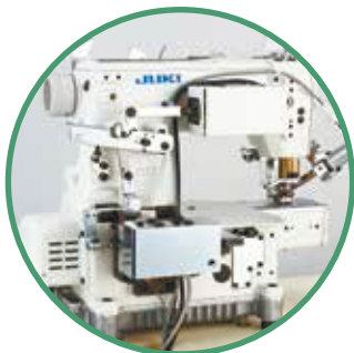
Магнит подъема прижимной лапки и магнит механизма обрезки
