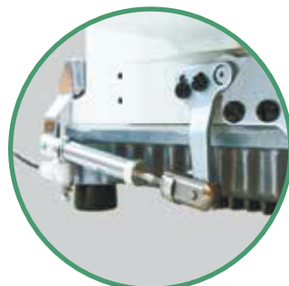
Устройство для учащения стежков в конце строчки, предотвращающее распускание нитей.
