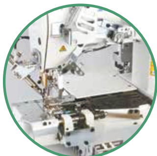
Пневматическое устройство обрезки игольной нити/нити петлителя
