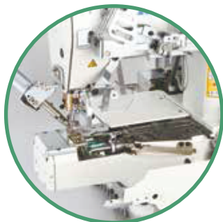
Электромагнитное устройство обрезки игольной нити/нити петлителя
