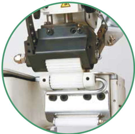
Ролик продвижения материалов зубчатого типа
