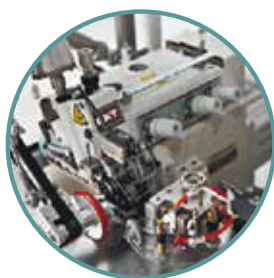
Прижимное устройство продвижения деталей кроя
