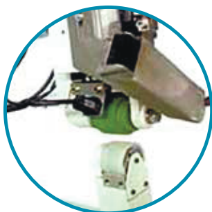
Инфракрасный термодатчик для точного регулирования температуры.
