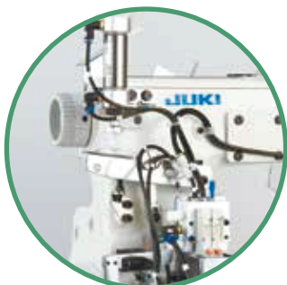
Пневмоцилиндр подъема лапки/Пневмоцилиндр механизма обрезки нитей
