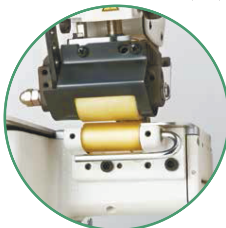
Ролик для продвижения материалов гладкого типа
