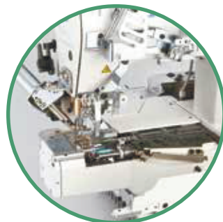
Электромагнитное устройство обрезки игольной нити/нити петлителя
