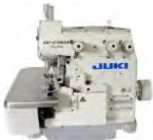
Краеобметочный трехниточный оверлок - «краевка», улучшенная система смазки
