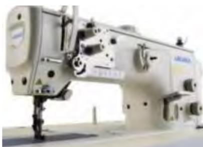
Двухигольная швейная машина челночного стежка с фрикционным приводом, с унисонной подачей и большим челноком с вертикальной осью вращения, увеличенный рукав (подрукавное пространство) 346 x 126 мм, мультифункция натяжения нити
