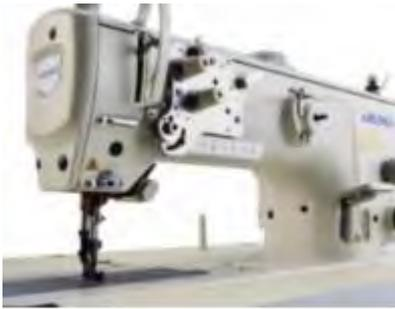
Высокоскоростная двухигольная машина челночного стежка с тройным продвижением и увеличенным в 2 раза челноком с вертикальной осью
