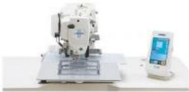
Швейная машина программируемой строчки с компьютерным управлением и функцией ввода данных.
