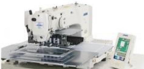
Швейная машина программируемой строчки с компьютерным управлением и функцией ввода данных
