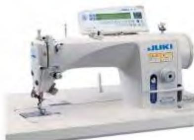
Высокоскоростная автоматическая одноигольная прямострочная машина челночного стежка с нижним продвижением, прямым приводом и автоматической обрезкой нити является передовой машиной Juki, работающей на предельно возможной скорости и содержащей различные технические характеристики, обеспечивающие энергосбережение. Серводвигатель прямого привода обеспечивает бесшумную работу машины, отсутствие вибрации.
