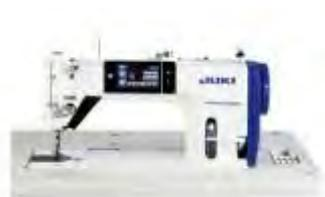
Одноигольная машина челночного стежка с нижним транспортером. Полностью цифровая модификация
