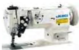
Машина Juki LU 1511 ND-7 предназначена для пошива изделий из тяжелых материалов. Наличие механизма с унисонной подачей обеспечивает ровную подачу материала любой толщины, что значительно облегчает процесс работы. При работе на данном оборудовании даже на высокой скорости качество строчек остается превосходным, не возникает проблем с пропуском стежков и не происходит сбороны ткани, сложенной в несколько слоев.
