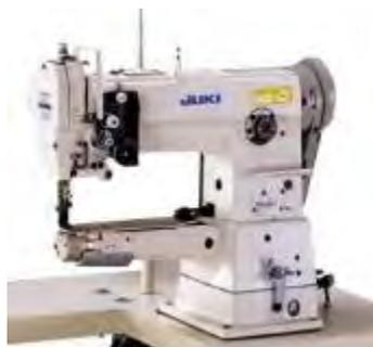
Одноигольная машина челночного стежка с цилиндрической платформой, с унисонным продвижением ткани (рейка, игла и лапка) и автоматическая смазка
