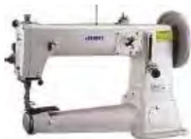
Одноигольная машина челночного стежка с цилиндрической платформой средней длины и большим качающимся челноком для шитья сверхтяжелых материалов, тройное продвижение (рейка, игла и лапка), диаметр рукава 81 мм, расстояние от иглы до рукоятки машины 420 мм, длина стежка 11 мм, подъем прижимной лапки 20 мм, скорость шитья 800 ст/мин.
