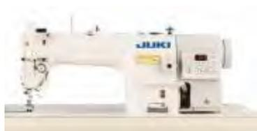
Высокоскоростная автоматическая одноигольная прямострочная машина челночного стежка с нижним продвижением, прямым приводом и автоматической обрезкой нити.
