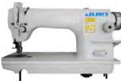
Одноигольная машина челночного стежка снижним и верхним транспортером (Шагающая лапа).
